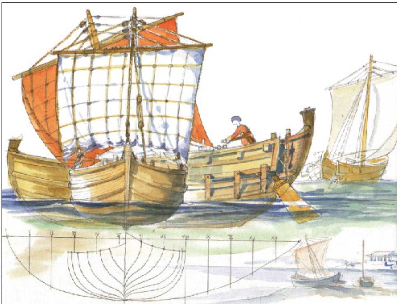
conduites dans le Rhône par le Drassm, correspondraient à des navires de mer. L'épave Arles-Rhône 13 se caractérise par une construction sur quille avec un assemblage de ses bordés par tenons et mortaises chevillées, caractéristique de la construction gréco-romaine. Datée du III<sup>e</sup> ou du IV<sup>e</sup> siècle apr. J.-C., sa longueur est évaluée à une vingtaine de mètres.
